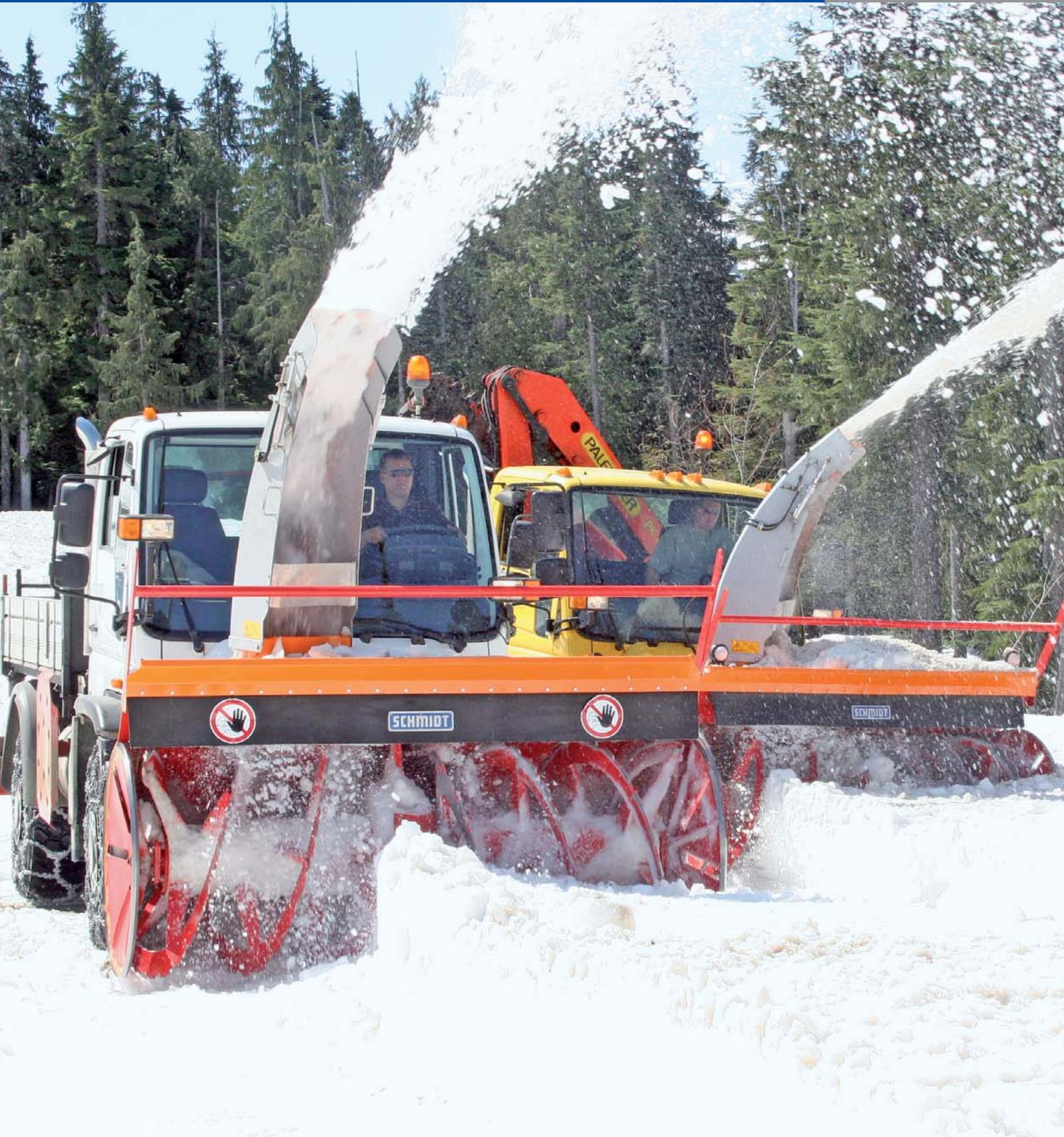
Die Reihe der robusten FS-Schneefrösschleudern zum Anbau an UNIMOG-Geräteträger und Traktoren ist für den Einsatz im harten kommunalen Winterdienst konzipiert. Sie wurden für effiziente Räumleistungen bei der Frontalräumung von hohem, hartem und vereistem Schnee entwickelt. Auch die Beseitigung von Randwällen, wie sie bei der Räumung durch Schneepflüge entstehen, ist möglich.
