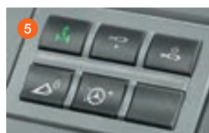
Bedienfeld Hydraulikzusatzfunktionen: Aktivierung Vorderachs-federung, Sicherheitsschalter Vorsatzgerä-terverriegelung Frontlader (FASTLOCK / SPEEDLINK), Pumpensum-mierung, Aktivierung Fronthydraulik
