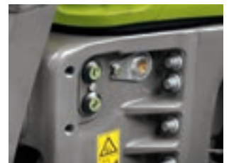
Über elektronische Steuergeräte kann der Frontkraftheber auch extern bedient werden.
