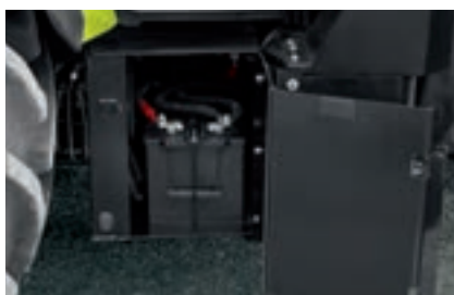
Rechts im Aufstieg, gut zugänglich, befinden sich die Batterie sowie ein Staufach für Werkzeug.
