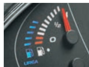
Anzeige der Füllstände von Harnstofflösung und Kraftstoff auf einen Blick im Armaturenbrett.
