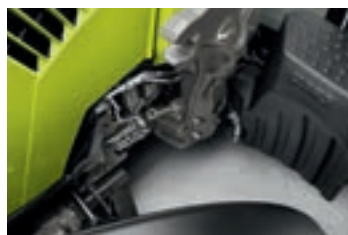
Der Motorölpeilstab ist auch bei angebaurem Frontlader leicht zu erreichen.
