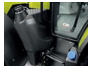
Einfüllstutzen für 17 bzw. 23 l Harnstofflösung und 142 bzw. 196 l Kraftstoff auf der linken Einstiegsseite.
