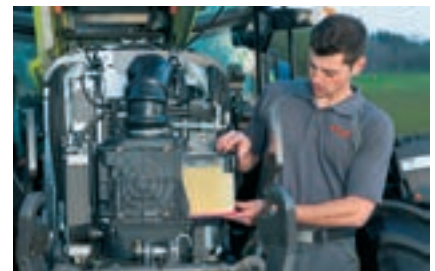
Einfache Entnahme des Motorluftfilters vor den Kühlern.
