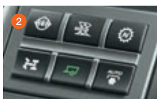
Bedienfeld Antriebsstrang: Differentialsperre, Allrad, Straßen- und Acker-Modus, Getriebe-neutralschaltung und die Aktivierung der automatischen Zapfwelle.
