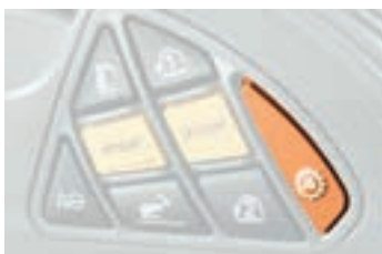
Aktivierung der QUADRACTIV Schaltautomatik optimal erreichbar auf dem Bedienfeld
