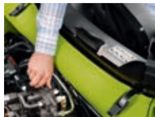
Das Sperr- und Umschaltventil des Frontkrafthebers ist bequem von der Kabine aus erreichbar.
