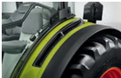
Die seitliche Ansaugung der Kabinenluft in den hinteren Kotflügeln sorgt für staubarme Luft und damit ein verlängertes Filterwartungs-Intervall.
