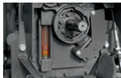
Einfache Kontrolle des Ölstands von Getriebe und Hydraulik im Schauglas neben der Zapfwelle.
