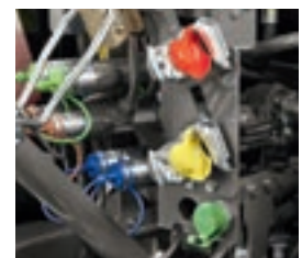
Druckluftbremsanlage und hydraulische Bremse sind auch in Kombination möglich.
