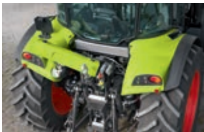
Einfache Erreichbarkeit des Kabinenluftfilters hinter der Kabine.
