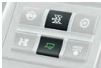
Umschalten von Transport- und Acker-Modus des Getriebes
